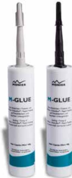
Als universeller Klebstoff wird M-Glue als Zubehörprodukt für die Abichtung von M-Flex und WrapTec verwendet. M-Glue besteht aus einem feuchtigkeitshärtenden 1-komponentigen silanmodifizierten Polymer (SMP). Der Kleber ist geruchslos, lösungsmittelfrei und enthält keine Phthalate. Besonderheiten sind die schnelle Aushärtung sowie eine bemerkenswerte Beständigkeit gegenüber starken klimatischen Einflüssen.
